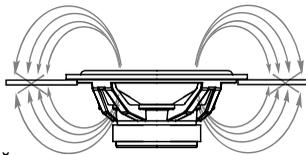
Поверхность, на которую производится установка динамика, должна быть по возможности жесткой и лишенной подвижности. Так, например при установке динамика в дверь, желательно укрепить ее обивку, которая при больших уровнях громкости может породить массу нежелательных призвуков. Все подвижные детали внутри двери (тяги, тросики и т.д.) необходимо по возможности «заглушить».
